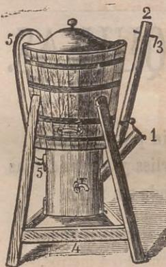
Su uso no puede ser más fácil; reduce á colocar la ropa, ceniza y agua según costumbre, encender fuego en el hornillo y llenar este de carbon. Sin otra operación, calentada la lejía convenientemente, sube por el tubo de ascension, cae encima de la ropa, filtra á través de esta para regresar de nuevo al aparato, y así sucesivamente por espacio de dos ó tres horas, tiempo suficiente para una colada perfecta, gastando escasamente un kilogramo y medio (4 libras) de carbon.
