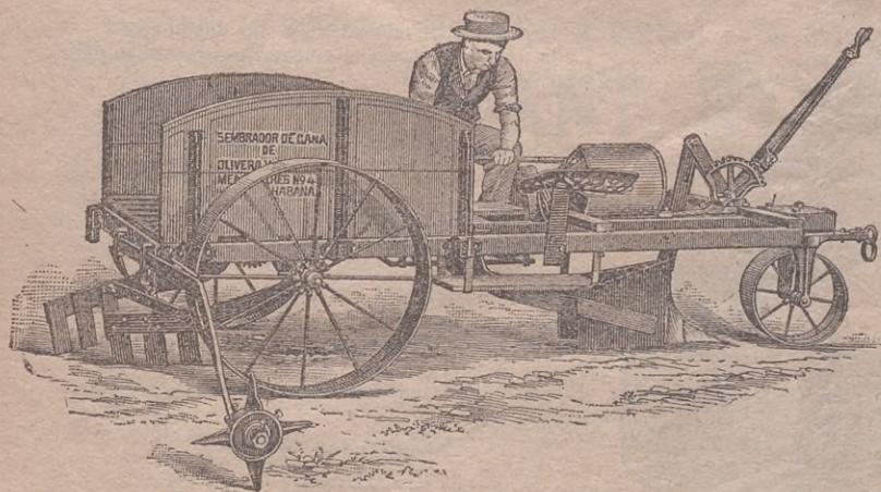
Conduce la caña, la corta en trozos de 14 pulgadas inglesas, abre el surco á la profundidad que se desee, riega la semilla á 18, 24, 30, 36 y 40 & pulgadas del narigón, tapa la semilla y marca el próximo surco á cualquier distancia.
