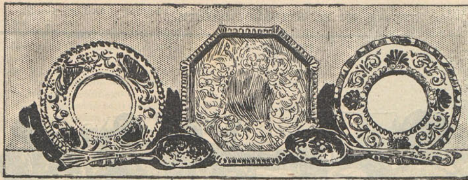
Algunos ejemplares de aluminio plateado por el nuevo procedimiento. El relieve está hecho con arreglo á un método especial trabajo de los mismos inventores.
