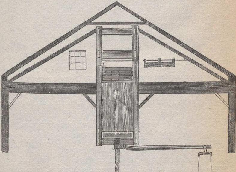
Este edificio tiene 40 piés intermuros y 60 de longitud con un tinglado de 10 piés para la prensa en un extremo. Le dejan 20 piés para elevar una plataforma á la altura del pié de la máquina de limpiar para la semilla de algodón, y los 40 piés restantes para el depósito de hila de algodón y para la prensa. Presentaré el extremo de la casa que tiene la prensa en la misma escala que el frente. La caja para el algodón se supone estar á ocho piés debajo de la puerta para sacar las pacas.
