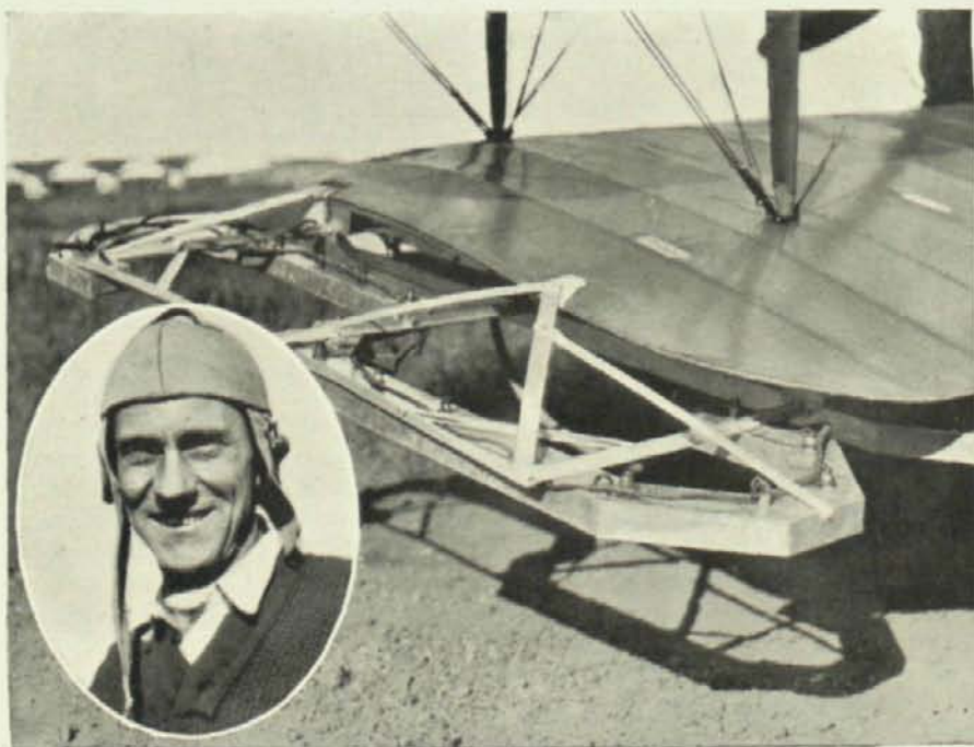
Aparato de iluminación eléctrica, adosable a las alas del aeroplano, para vuelos nocturnos, inventado por Peter La Grossa. En el óvalo, el inventor de este sistema de iluminación
