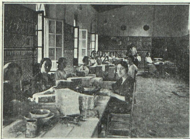
Obreras esmaltando azulejos.
