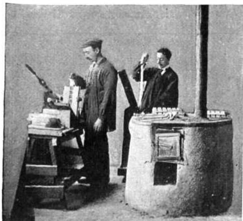
Antes de inventarse las máquinas para este objeto, se efectuaba la fundición según indica la presente fotografía. El obrero tomaba el cazo, lleno de metal líquido, y lo echaba en el molde sobre la matriz. La operación era trabajosa, larga, y nunca se podía producir material duro y perfecto.
