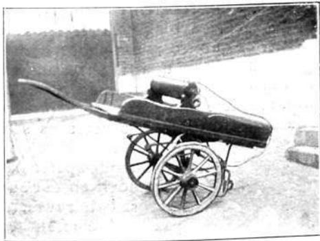
Carretilla empleada en los experimentos hechos por el autor de este artículo en la telegrafía sin hilos, utilizando las ruedas para la corriente de retorno.
