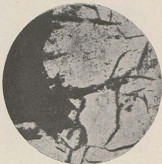
Fig. 15.—Microfotografía (150x) de un trozo de turbina de hierro fundido corroído por cavitación.
