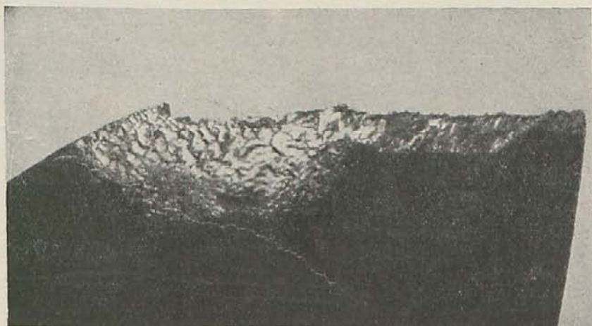
Fig. 4.—Trozo corroído de un alabe de acero dulce de un rodete Francis. Causa de la cavitación la misma que la de la fig. 3.
