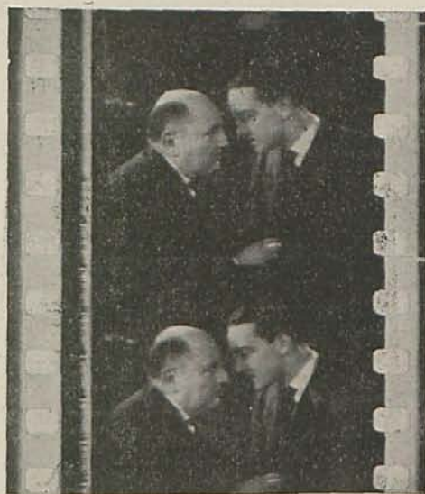
Trozo de película con impresión del sonido por el sistema Photophone, de ancho variable
