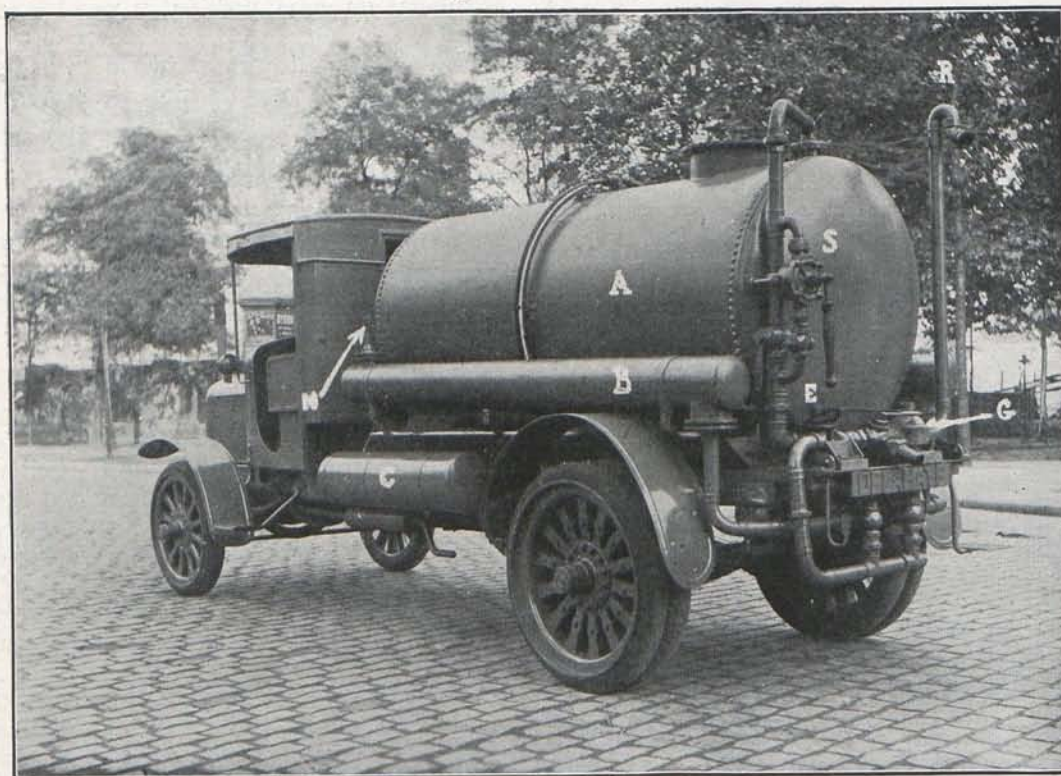
Camión-cisterna, para transporte y manipulación de carburantes: A, cuba-depósito; B, aparato elevador; C, depósito regulador de gas; E, llave de mando; G, contador de gasto; R, orificio de salida.
