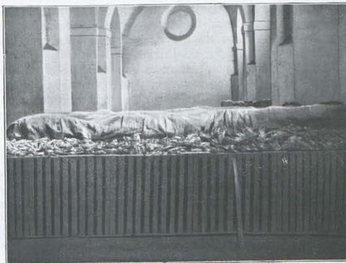
Pabell n de fermentaci n de la F brica de Tabacos de Sevilla. En primer t rmino, un pil n descubierto de 2.500 kilogramos. En segundo t rmino, un pil n arropado de 3.000 kilogramos.
