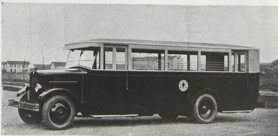
Modelo Berliet G.S.E.D. rebajado con carrocería de 26 asientos, todos hacia adelante, para servicio de población
