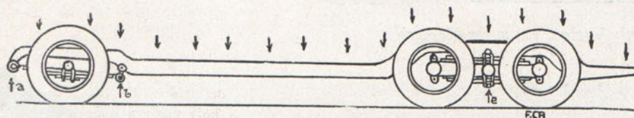
FIG. 2.—Condiciones de resistencia del mismo larguero montado en seis ruedas
