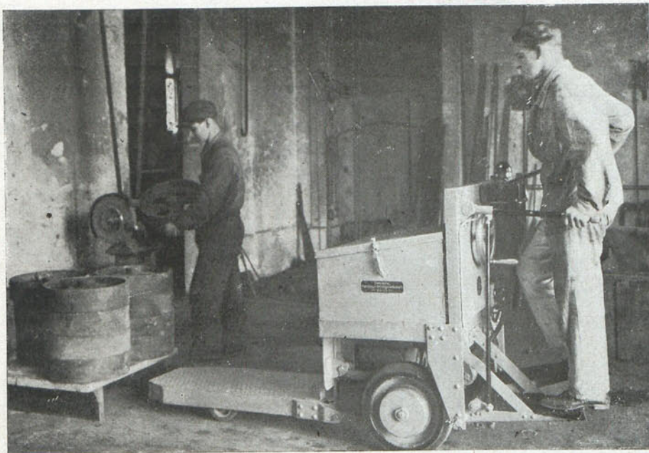
FIG. 2.—El carromato eléctrico en trabajo, va a recoger su carga, una serie de poleas que están rebarbando en un taller de fundición. La plataforma del carromato se meterá debajo de la peana en donde el obrero ha ido dejado las poleas
