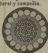
Cable subterráneo, Teléfono múltiple.
