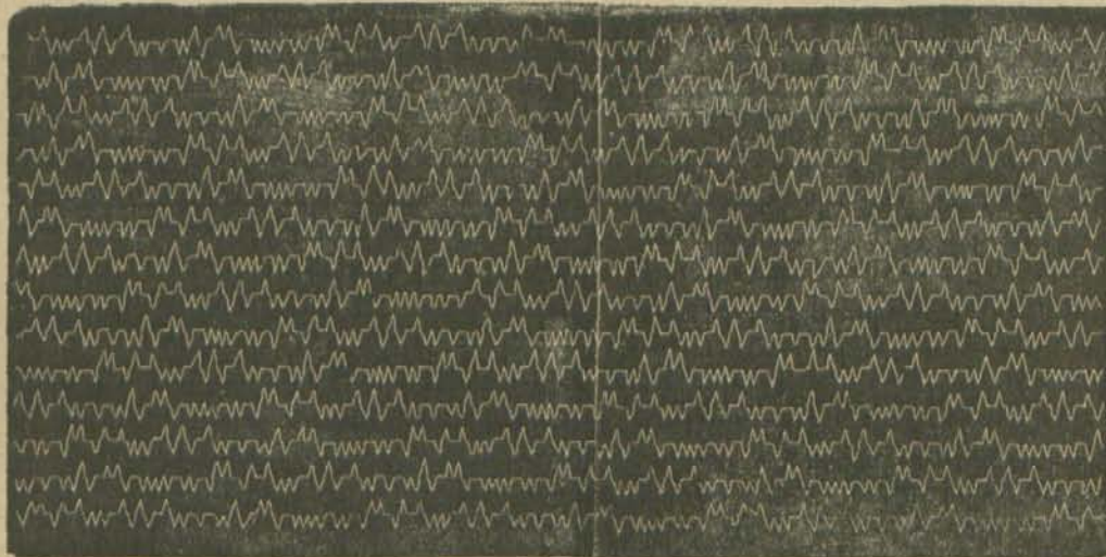
FIG. 4ª.—Cliché fotográfico de un telegrama recibido con el sistema de telegrafía rápida 'Poliak-Virag'.
