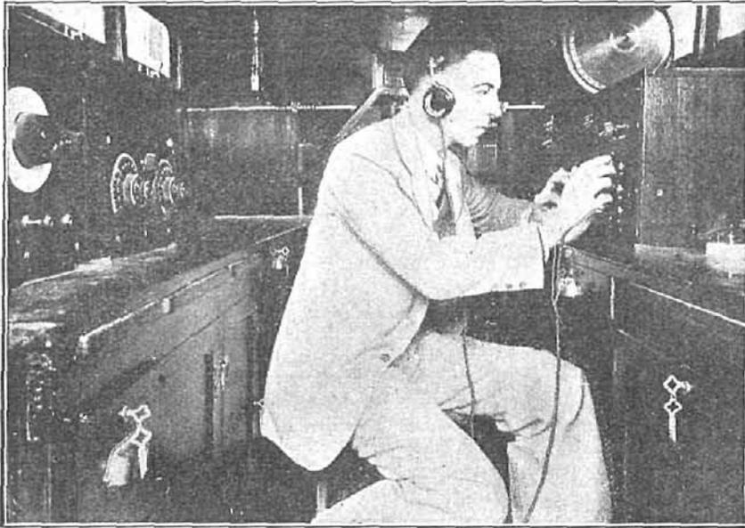
Equipo radiotelefónico del Departamento de Comercio de Londres, instalado en un automóvil y destinado a la comprobación de longitudes de ondas.
