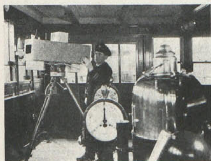
La cámara fotográfica para niebla instalada en el puente de mando de un buque.
