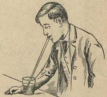
Esta figura muestra el efecto de la presión atmosférica sobre un líquido. Si aspiramos el aire contenido en un tubo, el líquido del vaso subirá por él, siempre que la altura vertical no exceda de nueve metros.
