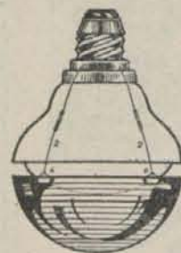
Lámpara de incandescencia cuya intensidad luminica puede graduarse a voluntad.
