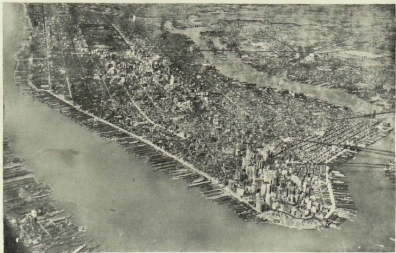
Estas fotografías representan la forma en que fué hecho el plano aéreo de Nueva York el 4 de Agosto de 1921. Para completarlo fueron necesarias 100 fotografías hechas desde aeroplano a la altura de 10.000 pies. Cubre 32 millas cuadradas de superficie. Este es el primer plano aéreo que se ha hecho de una ciudad
