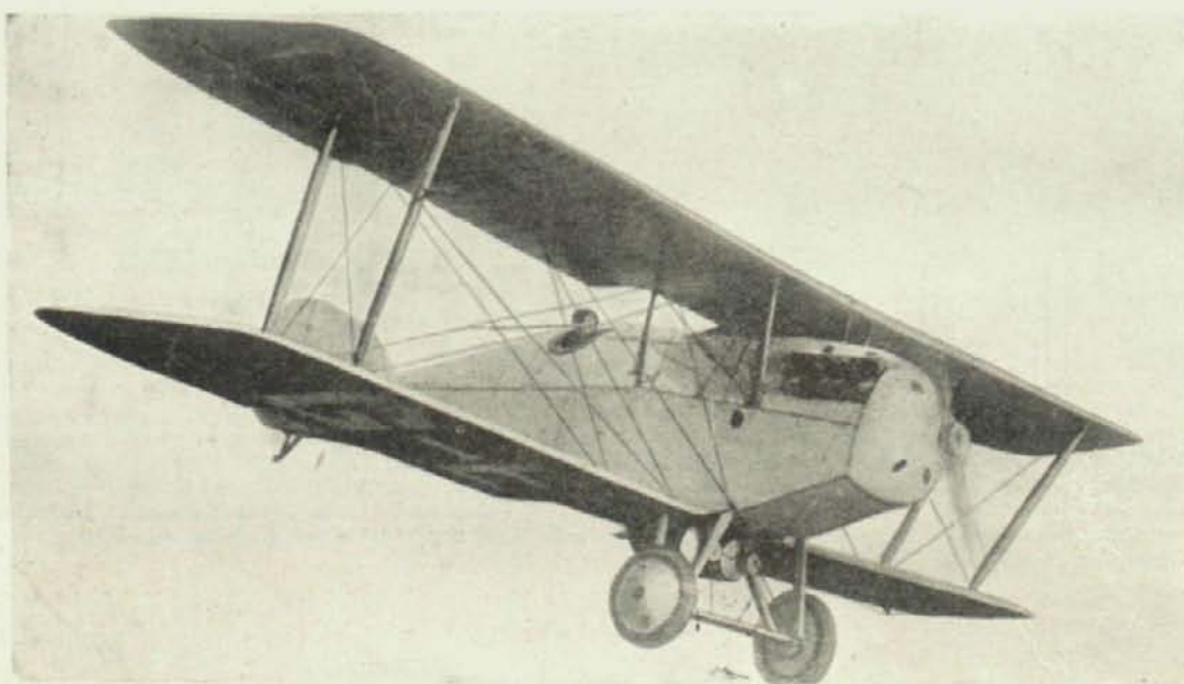
Martinsyde F. 4 (A), equipado con 300 HP. Hispano-Suiza y radiador Lamblin
