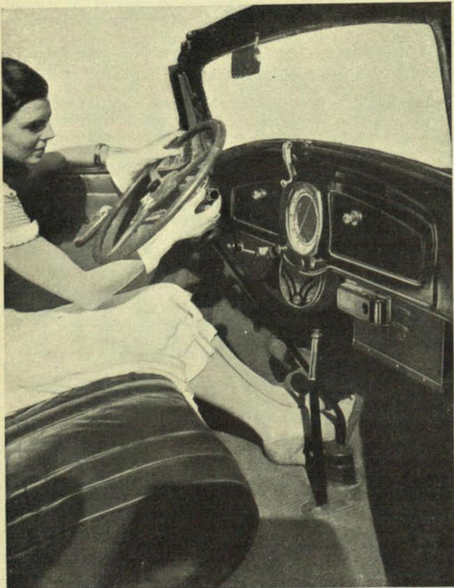
Una moderna instalación de radio en un automóvil: El mando, en el volante; el altavoz, en el centro, y el aparato, a la derecha.
