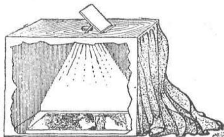
Modelo de una cámara oscura. Figura una pared rota para que se vea el interior.
