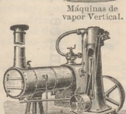
Máquinas de vapor verticales con calderas locomotivas.
