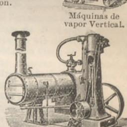
Máquinas de vapor verticales con calderas locomoviles.
