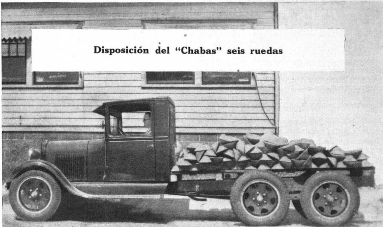
El sistema «Chabas» seis ruedas soporta la carga por igual entre los dos ejes y aumenta la longitud del chasis
