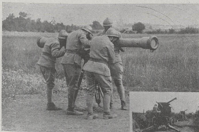
Telémetro estereoscópico de 3 m. de base, tipo S. O. M., en utilización
