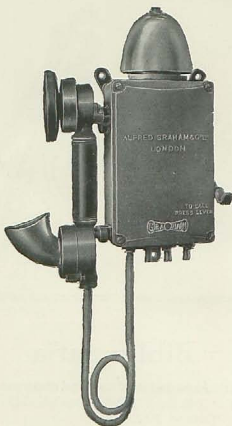
Fig. 1.—El teléfono de altavoz Triton .
