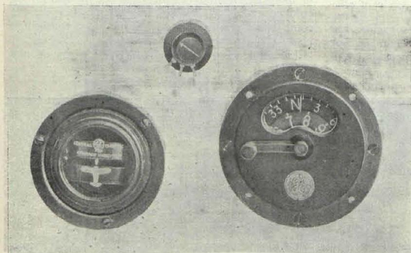
Fig. 4.—Indicador, control de ruta y control de sensibilidad.
