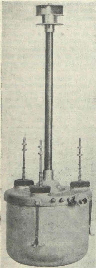
Fig. 1.—Magneto-brújula. Vista exterior con el molinete impulsor.
