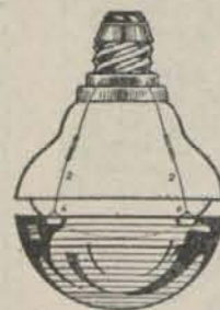
Lámpara de incandescencia cuya intensidad lumínica puede graduarse a voluntad.
