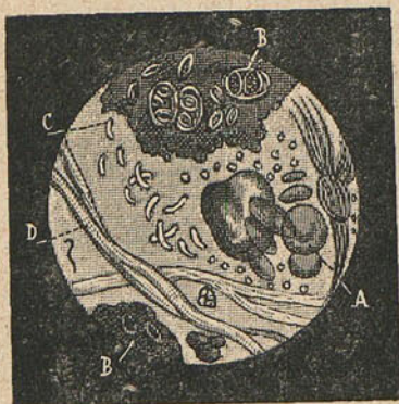
Pequeña parte de una incrustación vista a 300 diámetros de aumento
