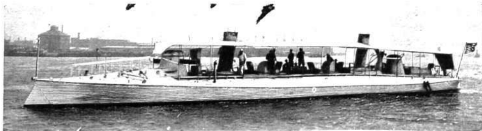
El torpedero Stiletto , de 31 toneladas y 359 caballos de vapor, construido en Bristol el año 1888 y famoso por su extraordinaria velocidad.
