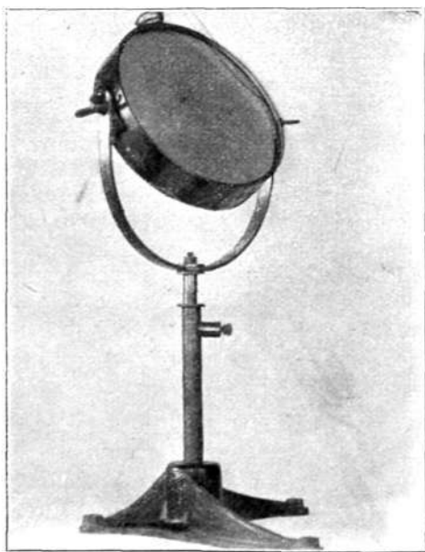
Aparato por medio del que se reconcentra la luz solar sobre la placa lúpica.
