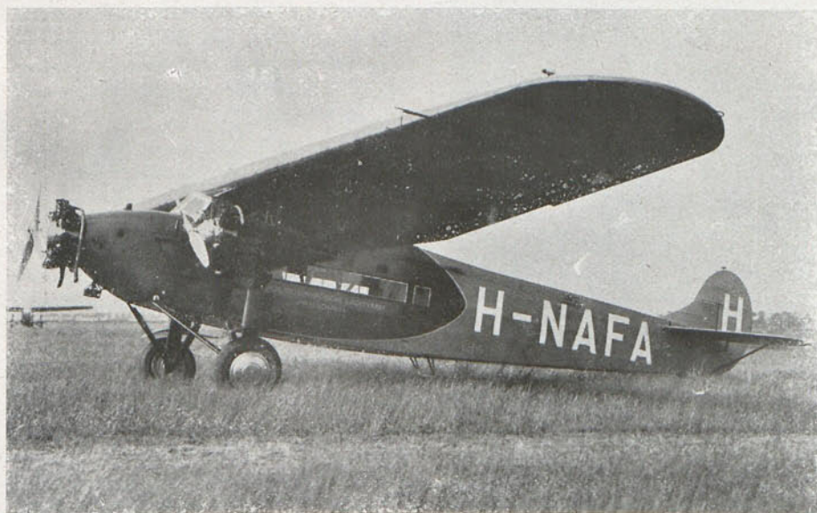
Aparato Fokker F.VII con tres motores Lynx, uno de los cuatro que hacen el servicio de Holanda con las Indias Orientales
