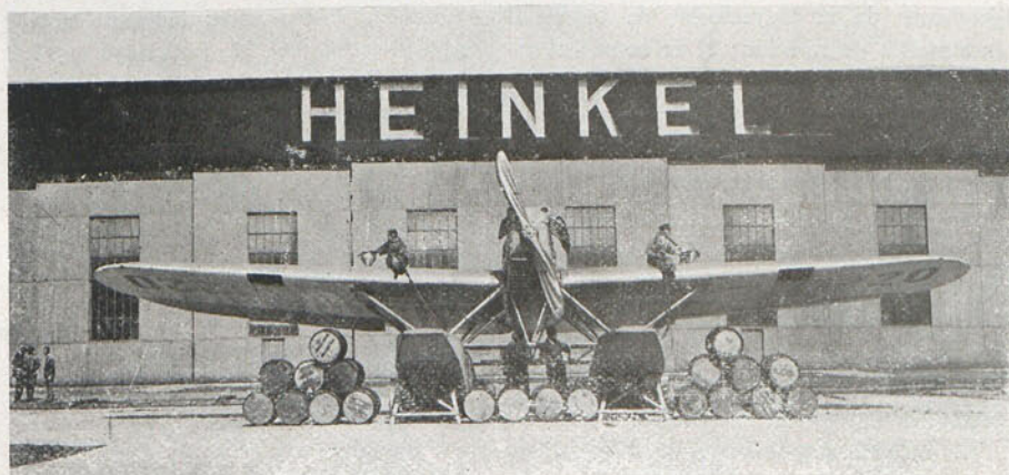
Preparativos para hacer un ensayo de resistencia de peso, de un hidroavión Heinkel
