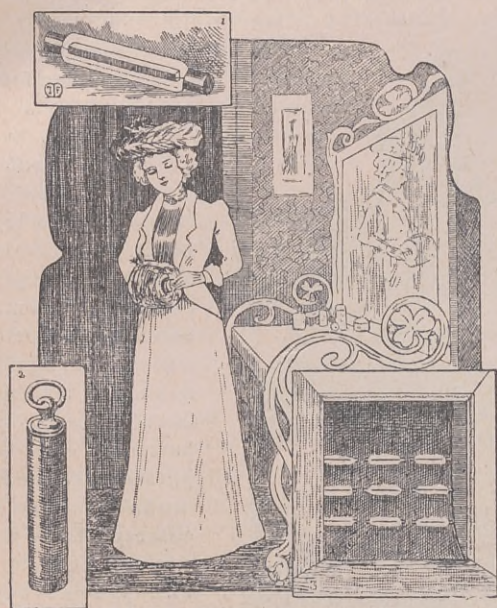
1. EL SUERO ELÉCTRICO.—2. CALORÍFERO DE MANGUITO. 3. CHIMENEA DE TUEROS ELÉCTRICOS
