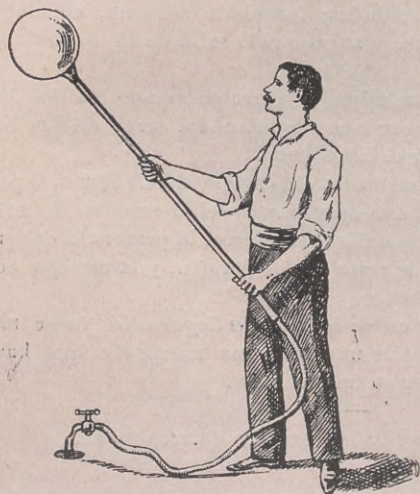
SOPLAGE DEL VIDRIO POR MEDIO DEL AIRE COMPRIMIDO
