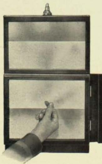
Ajuste definitivo: sostener el cristal al hacerlo deslizar por las ranuras.
