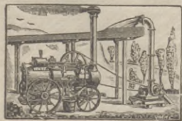
Bombas de vapor.
