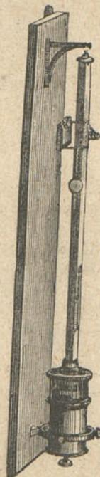
Figura 1.<sup>a</sup>—Barómetro de mercurio.
