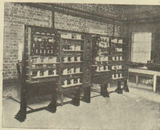
LA estación receptora de señales secretas emitidas desde el Canadá y Sudáfrica, se halla instalada en Bridgwater (Inglaterra), se ven aquí los dos receptores. Ambos utilizan dos longitudes de onda.
